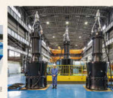
▲ 人工カヌー・スラロームコースの水流作りに貢献した国内最大級の水中ポンプSSP-1350GS型(吐出し口径1350mm、出力350kW)
