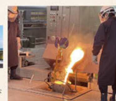
▲ アロイテクノロジー・鋳造事業部(八尾工場)竣工、ツルミグループ初の鋳造事業を開始 3Dプリンタによる砂型からの鋳造で、より高精度な部品製造が可能
