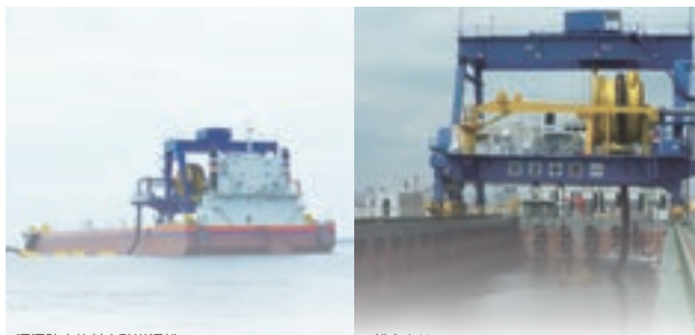
汚濁防止枠付土砂送泥船
