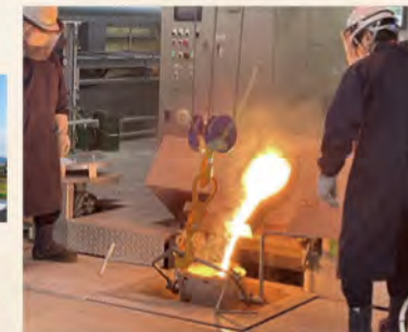
▲ アロイテクノロジー鑄造事業部(八尾工場)竣工、 ツルミグループ初の鑄造事業を開始 3Dプリンタによる砂型からの鑄造で、より高精度な 部品製造が可能
