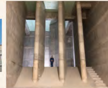
▲ 米子工場 新大型ポンプ生産棟竣工、 水深11m 保有水量3,500m³の大型試験水槽
