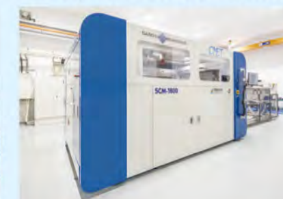
砂型積層造形装置(3Dプリンタ)
