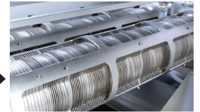
可動板内周摺接構造
