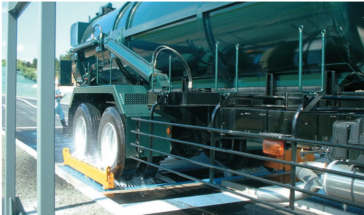
洗浄の噴射状況
